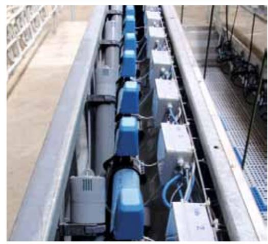
Уникальная конструкция доильных аппаратов DUTCHLAC практически полностью гарантирует отсутствие попадания инфекции и обеспечивает стабильный вакуум внутри доильных стаканов.
